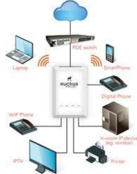
Il Zoneflex 7025 integra ad alta velocità 2.4GHz 802.11n Wi-Fi, con porte Ethernet cablate in un elegante, poco appariscente e basso profilo a muro che si inserisce in una scatola di derivazione elettrica. E 'ideale per l'offerta di connessioni multiple in strutture ricettive senza cavi multipli. Offre alte prestazioni copertura Wi-Fi e quattro connessioni cablate Ethernet e una porta aggiuntiva passthrough per telefoni digitali o altre applicazioni
